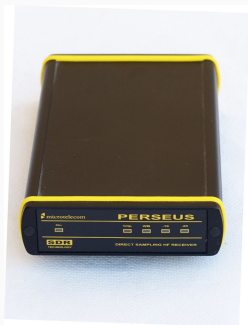
Obrázek 1: Příklad přijímače SDR [2].
